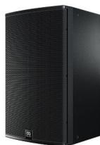
Cuboid 15 è un diffusore passivo full range dotato di un driver a bassa frequenza (LF) da 15" e un driver a compressione ad alta frequenza (HF) da 1" per avere chiarezza e potenza nelle medie ed alte frequenze. La sezione HF offre una copertura coerente su entrambi i piani grazie alla tromba ruotabile. Adatto alle corte e medie gittate.
