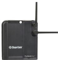
Antenna tranceiver attiva via IP. Può essere connesso in una rete AES67. Indicatori di stato a LED in alto e in basso al ricetrasmittitore con antenne omnidirezionali esterne. Supporta fino a 200 beltpack su un singolo sistema misto integrato (vedere la Capacity Chart per dettagli). Usa trasmissioni radio ridondanti per beltpack e separate per la scansione RF e radar, piastra per montaggio a parete, supporti per aste microfoniche, attacco per treppiede.
