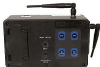
Può essere alimentata con l'alimentatore CA in dotazione, con batterie AA, con batterie ricaricabili o con una tensione di 12 Vcc da un'auto. Funziona con il beltpack wireless BP200 con cuffia opzionale
