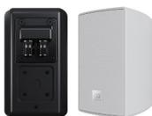
Cuboid 3 è un diffusore passivo full range dotato di un driver per le basse frequenze da 3,5" e un driver per le alte frequenze a cupola PEI da 0,5" accoppiato a una guida d'onda poco profonda per una distribuzione HF coerente. È disponibile una copertura per le connessioni, resistente agli agenti atmosferici, per uso esterno, che porta il grado di protezione a IP54.
