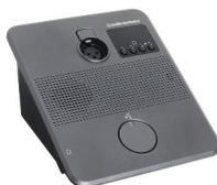
L'unità di discussione è compatta, multifunzione e programmabile con una superficie non riflettente progettata per l'installazione "ad incasso" o "a tavolino" con 3 punti di ancoraggio incorporati.
