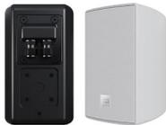
Cuboid 5 è un diffusore passivo full range dotato di un driver per le basse frequenze da 5,25" e un driver per le alte frequenze a cupola in seta da 0,75" accoppiato a una guida d'onda poco profonda per una distribuzione HF coerente. È disponibile una copertura per le connessioni, resistente agli agenti atmosferici, per uso esterno, che porta il grado di protezione a IP54.
