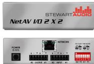
Il NetAV I/O 2x2 è un convertitore con 2 ingressi analogici/DANTE in 2 uscite DANTE/analogici per integrare reti locali con reti DANTE
