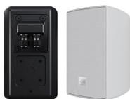
Cuboid 5 è un diffusore passivo full range dotato di un driver per le basse frequenze da 5,25" e un driver per le alte frequenze a cupola in seta da 0,75" accoppiato a una guida d'onda poco profonda per una distribuzione HF coerente. È disponibile una copertura per le connessioni, resistente agli agenti atmosferici, per uso esterno, che porta il grado di protezione a IP54.
