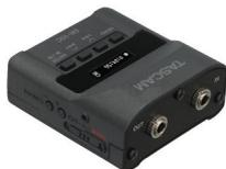
Registratore compatto per lavalier Sennheiser 3,5mm mini jack (dual mono output), con porta IN-OUT.
