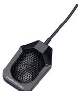
Microfono "boundary" a condensatore emi-cardioide miniaturizzato colore nero. Cavo con connettore di uscita spinotto XLR da 7,6 mt.. Capsula: Condensatore; Polare: emi-cardioide; Risposta: 70-14.000 Hz; Sensibilità.: -38 dB (12,5 mV); Impedenza.: 100 Ohm; Rapporto Segnale/Rumore.: 65 dB 1 kHz @ 1 Pa; Gamma: 105 dB, 1 kHz @ Max. SPL; Phantom: 9-52V c. c. 2 mA tipica.
