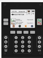
Unità da tavolo compatibile con i DSP Symetrix che montano interfacce telefoniche (VoIP o analogica)
