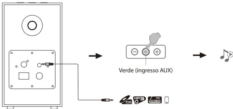
1. Collegare la sorgente audio (telefono cellulare, tablet, ecc.) alla porta di AUX sul pannello posteriore dell'altoparlante attivo utilizzando un cavo audio;
