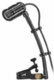
Microfono per radiomicrofono a condensatore cardioide per strumenti - Comptibile con tutti i supporti di montaggio serie AT8491x - Risposta in frequenza 40-20.000 Hz - Impedenza: 50 Ohm - Max livello sonoro in Ingresso 149 dB SPL, 1 kHz at 1% T.H.D. - Peso microfono 14,5 g - Cavo 4 m - Capsula intercambiabile opzionali: UE-H ipercardiode, UE-O Omnidirezionale
