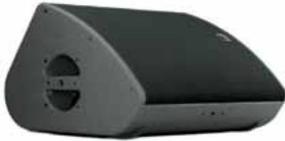
Diffusore passivo, coassiale compatto a 2 vie pilotato da controller amplificati compatibili: LA4X - LA8 - LA12X. - Larghezza di banda (-10 dB): 55 Hz - 20 kHz ([X15] preset) - Direttività nominale (-6dB): HxV 40° x 60°
