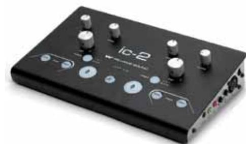
Unità che permette l'interpretazione simultanea di una o più lingue. Consente di monitorare il segnale "floor" o "relay", attivare gli ingressi del microfono e di instradare il segnale dell'interprete a uno o ai due gruppi di lingue. Ideale per presentazioni multilingue (fino a un massimo di 14), dove vengono usati un solo "floor" e "relay"
