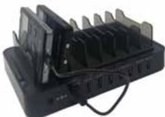
Caricatore per 8 ricevitori WF R1 con cavi USB micro B
