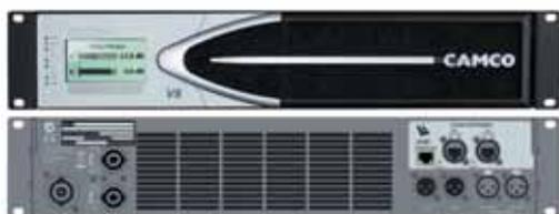
Amplificatore di potenza con una stabilità fino a 1 Ohm e la capacità di lavorare in Stereo, Bridge Mono e Mono in parallelo
