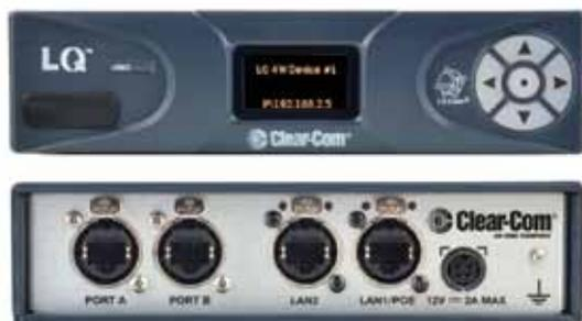
L'Q-4W2 può essere connesso a vari dispositivi, come ad I/O analogici di qualsiasi intercom a matrice, a circuiti telefonici analogici, gateway radio a due vie e mixer audio
