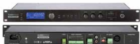
Il lettore Weekly Player è progettato per riprodurre i messaggi programmati, salvati su SD, ma può essere utilizzato per riprodurre anche musica di sottofondo. Dispone di ingresso microfono con priorità e alimentazione phantom, supporta il controllo remoto per play e stop dei messaggi tramite 8 contatti puliti domotici.
