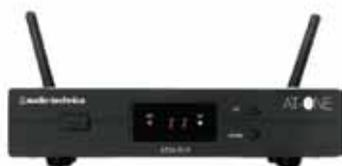
Ricevitore 2 x 4 canali di frequenza, con sistema antenna switching diversity
