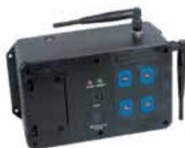
Può essere alimentata con l'alimentatore CA in dotazione, con batterie AA, con batterie ricaricabili o con una tensione di 12 Vcc da un'auto
