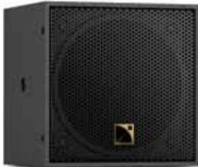
Diffusore passivo, coassiale compatto a 2 vie pilotato da controller amplificati compatibili: LA4X - LA8 - LA12X. - Larghezza di banda (-10 dB): 120Hz - 20 kHz ([4Xi] preset) - Direttività nominale (-6dB): 110° simmetrico sull'asse - SPL massima 116 dB ([4X] preset).
