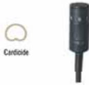
Microfono lavalier condensatore, cardioide, per strumenti - Risposta in frequenza 50-15.000 Hz - Filtro di attenuazione dei bassi 80 Hz, 12 dB / ottava - Sensibilità a circuito aperto - 45 dB (5,6 mV) rif. 1V @ 1 Pa - Impedenza 250 ohm
