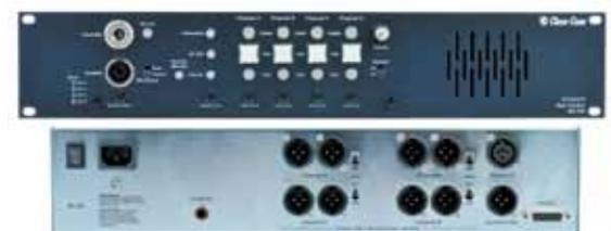
La MS-704 è una Main Station per intercom a quattro canali con pulsanti di programmazione sul pannello frontale - La MS-704 è dotata di alimentatore interno da 2A, con protezione contro i cortocircuiti
