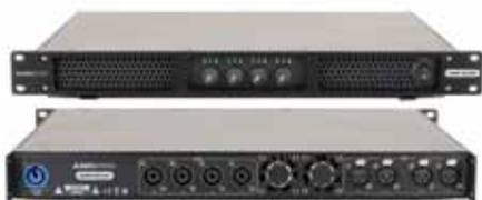
Amplificatore a 4 canali 4 x 350 W (8 Ω), 4 x 500 W (4 Ω), 4 x 600 W (2 Ω)
