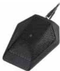
Microfono "boundary" da superficie condensatore cardioide, con tecnologia UniGuard™ (immunità alle interferenze da radio frequenze) e connettore rotante TA3F PivotPoint®. Alimentazione Phantom, finitura nero a bassa riflessione,. Capsula: Condensatore; Polarizzata: Cardioide; La capsula è intercambiabile con elementi UE-C cardioide (120°), UE-H hypercardioide (100°), UE-O omnidirezionale (360°).
