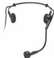
Microfono per radiomicrofono headset condensatore polarizzato con braccio flessibile pivotante per utilizzo sia a destra che a sinistra
