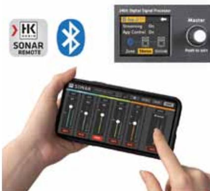
L'APP per tablet e smartphone (iOS e Android) offre molto più di un semplice controllo da remoto del mixer digitale interno ai diffusori. Ti permette, ad esempio, di controllare tutte le configurazioni e le funzioni inclusi i parametri dell'EQ a 3 bande, per ogni canale, oppure salvare le scene per avere sempre disponibili i preset più utilizzati.
