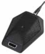
Microfono "boundary" da superficie condensatore cardioide con un interruttore con LED sensibile al tocco che può essere impostato su tre modalità: tocco on / off, tocco per parlare e tocco per disattivare. Il LED può essere impostato in 7 diversi colori. Connettore TB3M di uscita rotante PivotPoint®.
