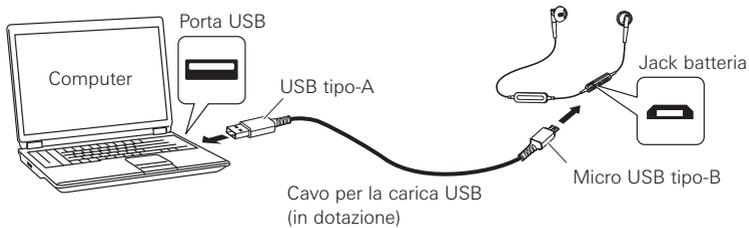
3. Collegare il cavo per la ricarica USB in dotazione (USB tipo-A) al computer per iniziare la ricarica.
