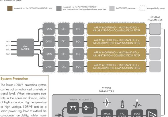
FIR FILTERS - ZERO PHASE SHIFT, LINEAR PHASE FIR
