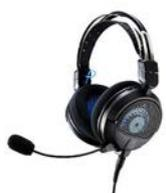
Cuffia aperta per gaming con archetto flessibile per microfono. Microfono a condensatore, ipercardioidale. Driver da 45 mm. Risposta in frequenza: 10 - 35.000 Hz (cuffia); 30 - 20.000 Hz (mic). Impedenza: 45 ohm; Sensibilità: cuffia 98 dB/mW, mic -43 dB (1 V/Pa, at 1 kHz).
