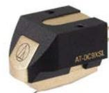
Testina con stilo Special Line Contact Moving Coil. Doppia bobina mobile Pure Copper di Ohno Continuous Casting (PCOCC), separazione dei canali 28 dB (1 kHz). Risposta in frequenza 20 - 50.000 Hz. Impedenza di carico consigliata: minima 100 ohm. Cantilever 0,28 mm ø nude in boro. Stilo Special Line Contact Nude rectangular shank. Peso 7,6 gr. Accessori di montaggio inclusi.
