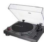
Giradischi a trazione diretta con servo motore a corrente continua; Uscita USB; Braccio ad "S" in alluminio con controllo idraulico. Testina AT-VM95E e portatestina AT-HS6. Illuminazione a scomparsa per un preciso posizionamento della puntina; Controllo anti-skate
