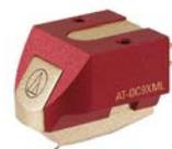
Testina con stilo MicroLine® Moving Coil. Doppia bobina mobile Pure Copper di Ohno Continuous Casting (PCOCC), separazione dei canali 25 dB (1 kHz). Risposta in frequenza 20 - 47.000 Hz. Impedenza di carico consigliata: minima 100 ohm. Cantilever in alluminio. Stilo MicroLine® Nude square shank. Peso 7,6 gr. Accessori di montaggio inclusi.
