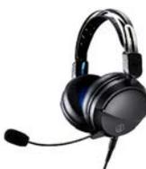
Cuffia chiusa per gaming con archetto flessibile per microfono. Microfono a condensatore, ipercardiode. Driver da 45 mm. Risposta in frequenza: 10 - 35.000 Hz (cuffia); 30 - 20.000 Hz (mic). Impedenza: 45 ohm; Sensibilità: cuffia 98 dB/mW, mic -43 dB (1 V/Pa, at 1 kHz). Peso: solo cuffia 230 gr., con microfono 237 gr.
