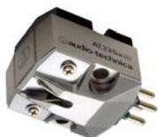
Testina con stilo Shibata Moving Coil. Doppia bobina mobile, separazione dei canali 30 dB (1 kHz). Risposta in frequenza 15 - 50.000 Hz. Impedenza di carico consigliata: minima 100 ohm. Cantilever conico in boro nude. Stilo Shibata Nude tapered boron. Peso 6,9 gr. Accessori di montaggio inclusi.
