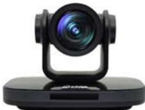
Telecamera PTZ 4K con PoE con autotracking. Sensore CMOS 1/2.8". Zoom ottico 12X. Campo visivo da 80.8° a 7.5°. Funzionalità Autofocus, Autotracking, WDR e riduzione rumore. Connettività di uscita: n.1 3G-SDI, n.1 HDMI 4KP60/50 /30/ 25/59.94 /29.97, n.1 USB 3.0 (type-C) audio e video out, n.1 RJ45 PoE (Lan 10/100/1000Mbps). Interfaccia seriale: RS232 in&out / RS485. Protocolli supportati VISCA / Pelco-D / Pelco-P. Uscita simultanea su HDMI, 3G-SDI ed RJ45. Ingresso audio: n.1 3,5mm mini jack.
