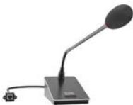
Microfono a collo d'oca con base DANTE Supercardioida a condensatore con alimentazione PoE. Risposta in frequenza 100 Hz - 16 KHz. Rapporto segnale-rumore 65 dB, 1Khz. Sensibilità -40dB. Uscita Ethernet Standard RJ45, DANTE network: 100 Mbps or superiore CAT5 o CAT6 network. Consumo 1,5 W. Alimentazione PoE IEEE 802.3AF standard
