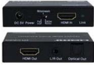
Audio De-Embedder (Extrattor) HDMI 18 Gbps con HDCP 2.2. Conforme a HDMI 2.0b (18 Gbps), HDCP 2.2 e DVI. Risoluzioni video fino a 4K2K@50/60Hz (YUV444). Estrae l'audio HDMI in audio ottico multicanale (SPDIF) o analogico L/R. L'audio ottico supporta LPCM 2CH, Dobyly Digital 2/5.1 CH, DTS 2/5.1CH. Pass-through audio HDMI High Bit Rate (HBR). Frequenze di campionamento audio fino a 192 kHz ~ 10 bit Pass-through HDR. Bypass CEC.
