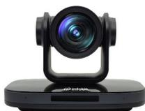
Telecamera PTZ 4K con PoE con autotracking. Sensore CMOS 1/2.8". Zoom ottico 12X. Campo visivo da 80.8° a 7.5°. Funzionalità Autofocus, Autotracking, WDR e riduzione rumore. Connettività di uscita: n.1 3G-SDI, n.1 HDMI 4K60/50 /30/ 25/59.94 /29.97, n.1 USB 3.0 (type-C) audio e video out, n.1 RJ45 PoE (Lan 10/100/1000Mbps). Interfaccia seriale: RS232 in&out / RS485. Protocolli supportati VISCA / Pelco-D / Pelco-P. Uscita simultanea su HDMI, 3G-SDI ed RJ45. Ingresso audio: n.1 3,5mm mini jack.
