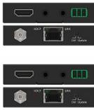
Kit Extender HDMI - HDBT (70m@1080p o 40m@4K). Comprende n.1 **E70C-T** trasmettitore HDMI - HDBT e n.1 **E70C-R** ricevitore HDBT-HDMI; max 70m @1080p/60Hz, max 40 m @ 4K/ 30Kz 4:4:4 o 4K/ 60Hz 4:2:0, su cavo Cat 6A; Compatibile HDMI 1.4, 10.2Gbps, HDCP 2.2, HDBaseT. Supporta segnale IR (n. 2 connettori mini Jack per IR IN e IR OUT sia su Tx che RX) e RS232 Bidirezionale. Alimentabile da un solo lato ( o TX o RX); In dotazione: alimentatore con connettore a vite ed IR Receiver & Emitter.
