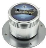
Eccitatore dinamico per superfici in cartongesso, professionale con tecnologia a doppia bobina; Potenza 30W RMS; Impedenza 8 ohms; Massima pressione sonora su cartongesso 88,8 dB; Risposta in frequenza 60 - 15KHz; Dispersione 120°; Connettore a vite; Dimensioni: 52,32 mm. (H) x 58,42 mm. (Ø); Peso 0,54 Kg.
