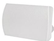
Diffusore da installazione a parete DANTE e AES67 a due vie coassiale, woofer in polipropilene da 8" con rivestimento in tessuto e tweeter da 1" soft dome, con la tecnologia brevettata della guida d'onda BroadBeam Ring™ per medio-alti chiari e migliori prestazioni fuori asse. Angolo di dispersione 95° Orizzontale 100° Verticale (media 2-10 KHz). Bassa latenza. Risposta 55-20 KHz (-10dB); SPL Max 97 dB @PoE; Cabinet in ABS (HIPS) e griglia in alluminio. Colore bianco
