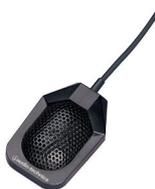
Microfono "boundary" a condensatore emi-cardioide miniaturizzato colore nero. Cavo con connettore di uscita spinotto XLR da 7,6 mt.. Capsula: Condensatore; Polare: emi-cardioide; Risposta: 70-14.000 Hz; Sensibilità.: -38 dB (12,5 mV); Impedenza .: 100 Ohm; Rapporto Segnale/Rumore.: 65 dB 1 kHz @ 1 Pa; Gamma: 105 dB, 1 kHz @ Max. SPL; Phantom: 9-52V c. c. 2 mA tipica.
