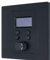
Controller da parete programmabile per MX-8A Matrix Mixer. 4 pulsanti più encoder per selezionare 4 o 8 sorgenti audio e controlli di volume, mute. Adatto per le installazioni. E possibile installare più controller in dasy-chain via RE-485, lunghezza massima cavo 200 m. Dimensioni: 87 x 87 x 54 mm. Peso: 0,14 Kg
