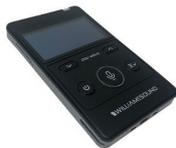
Ricetrasmittitore wireless digitale per sistemi Digi-wave.
