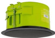
Diffusore da incasso a due vie coassiale, woofer in polipropilene da 8" con rivestimento in gomma e tweeter da 1" con cupola in seta. Angolo di dispersione 95° (media 2-10 KHz). Commutatore a sei posizioni 25 - 70,7 - 100 volt di facile accesso, trasformatore da 64 W. Risposta 65-22 KHz (-10dB); Potenza 64W RMS a 16 ohms; Sensibilità 89 dB 1w\1mt. SPL Max 107 dB @ 1m; Contenitore in alluminio e griglia in acciaio magnetica verniciabile. Colore nero
