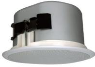
Diffusore da incasso a due vie, woofer in polipropilene da 8" e tweeter da 1" convesso in alluminio con raffreddamento FerroFluid montato su un deflettore e dissipatore di calore in fusione di alluminio. Meccanismo di montaggio rapido.
