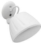
L'SM31-EZ è un altoparlante premium, montaggio a parete, da 3" full range. L'altoparlante incorpora un meccanismo di montaggio resistente ai furti e alla corrosione con giunto girevole indicizzato per un puntamento emisferico completo. I componenti degli altoparlanti SM31-EZ sono stati resistenti agli agenti atmosferici per applicazioni interne ed esterne. SM31-EZ è un altoparlante da 8 ohm con un involucro in ABS ZeroReflection™ a profilo ultrabasso. Grado di protezione IP: IP64.
