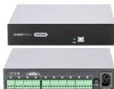
Processore di segnale digitale 4 IN - 6 OUT per l'elaborazione e il routing dei segnali audio a livello di linea.
