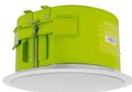
Diffusore da incasso a due vie coassiale, woofer in polipropilene da 8" con rivestimento in gomma e tweeter da 1" con cupola in seta. Angolo di dispersione 95° (media 2-10 KHz). Commutatore a sei posizioni 25 - 70,7 - 100 volt di facile accesso, trasformatore da 64 W. Risposta 65-22 KHz (-10dB); Potenza 64W RMS a 16 ohms; Sensibilità 89 dB 1w\1mt. SPL Max 107 dB @ 1m; Contenitore in alluminio e griglia in acciaio magnetica verniciabile. Colore bianco
