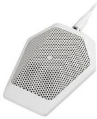
Microfono "boundary" da superficie condensatore cardioide, con tecnologia UniGuard™ (immunità alle interferenze da radio frequenze) e connettore rotante TA3F PivotPoint®. Alimentazione Phantom, finitura bianca a bassa riflessione,. Capsula: Condensatore; Polarizzata: Cardioide; La capsula è intercambiabile con elementi UE-C cardioide (120°), UE-H hypercardioide (100°), UE-O omnidirezionale (360°).
