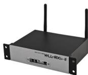
Ricevitore di segnale audio wireless con amplificatore a 2 canali da 50 W/ch in classe D. 3 canali di frequenza commutabili per ridurre i problemi derivanti da interferenze; ogni canale lavora su 3 bande (2.4, 5.2, 5.8 GHz).
