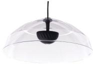
Diffusori ad alta direttività SoundDome (TM) realizzati con una semisfera in polimeri PETG trasparente ed altoparlante sul punto di fuoco stereofonico. Sospensione attraverso un gancio di attacco. 2 altoparlanti da 1" (25 mm) ad alta direttività. Tecnologia brevettata della semisfera ZeroReflection™ per una riproduzione accurata del suono.
