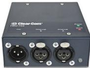
Adattatore che combina due singoli canali da un sistema partyline Clear-Com a una linea TW, consentendo l'aggiunta di un segmento TW a doppio canale a qualsiasi sistema partyline Clear-Com. La connettività TW fornisce al sistema la semplicità del cablaggio XLR a 3 pin standard quando si utilizzano stazioni utente compatibili TW, come il beltpack RS-703.
