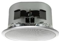
Diffusore da incasso a due vie, woofer in polipropilene da 8" e tweeter da 1,42" convesso in alluminio con raffreddamento FerroFluid montato su un deflettore e dissipatore di calore in fusione di alluminio. Meccanismo di montaggio rapido.
