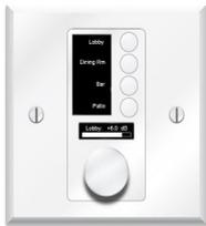
Il W3 è un controllo remoto da incasso che comunica attraverso la rete IP con i processori di segnale Symetrix e che può essere configurato e programmato tramite il software Composer. Alimentazione PoE.
