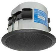
Diffusore da incasso omnidirezionale, woofer in polipropilene da 5,25" e tweeter da 1" convesso in titanio con raffreddamento FerroFluid montato su un deflettore e dissipatore di calore in fusione di alluminio proprietari,
