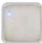
Antenna ricetrasmittente ad infrarossi dal design moderno e discreto. Si collega all'unità di controllo centrale tramite un cavo coassiale BNC da 75Ω. Indicatore di alimentazione a LED. Copertura fino a 7mt/φ. Staffa di montaggio a soffitto inclusa, colore bianco. Max 16 antenne collegabili per ogni sistema ibrido.
