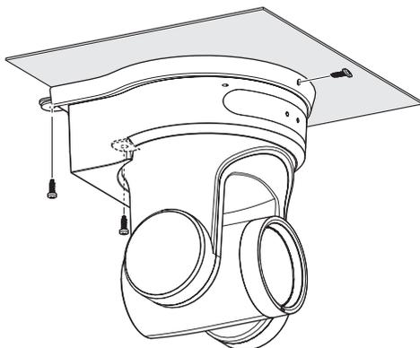
Fissare il cavo anticaduta (venduto separatamente) insieme a una delle viti.
