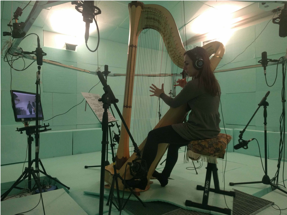
Figura 4: Posizione dei musicisti durante le registrazioni con l'array di microfoni intorno all'esecutore e il monitor con il direttore
