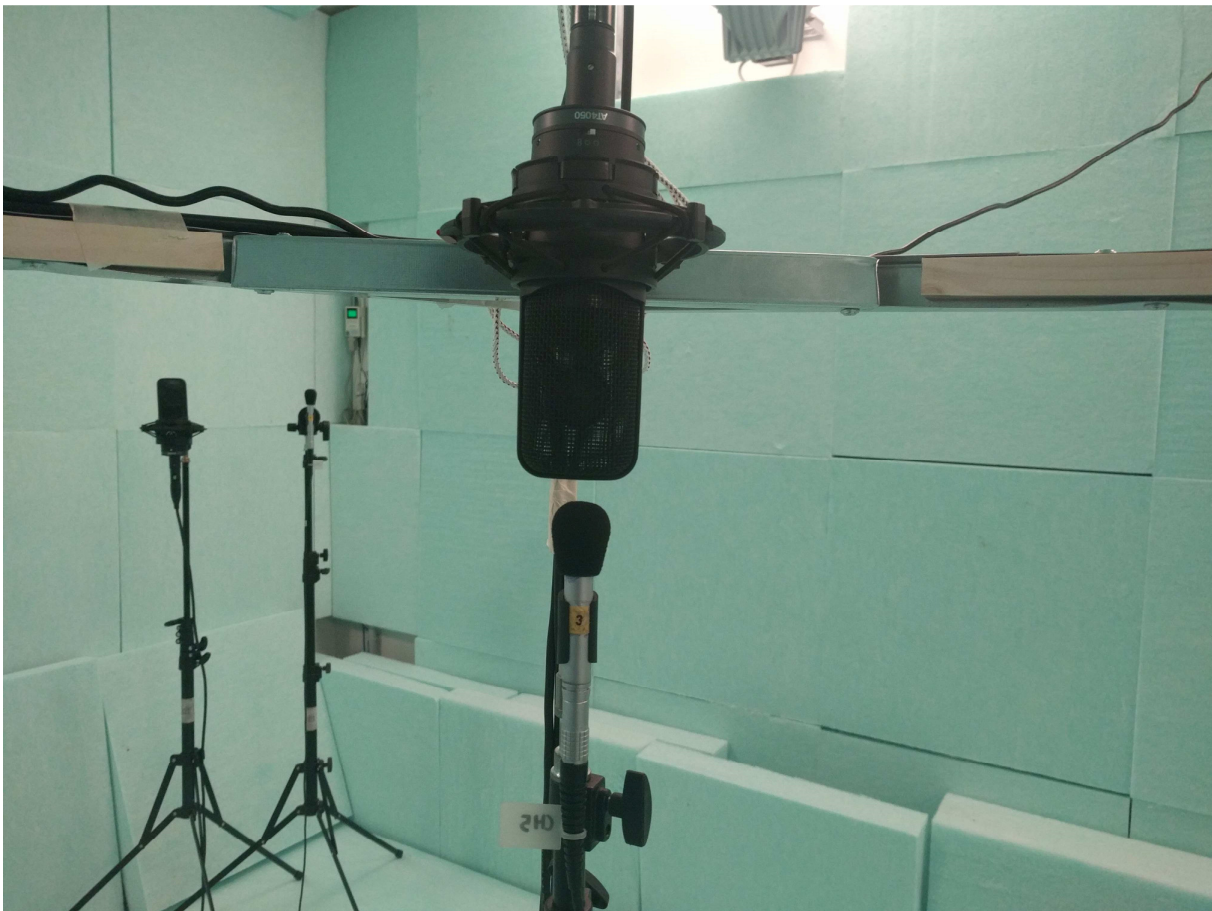
Figura 6: Dettaglio con il microfono B&K 4190 usato come riferimento strumentale e uno dei microfoni di registrazione AT 4050.
